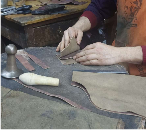
Fotoğraf 3. Tıpa oluğu derisi kesimi
