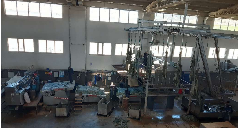
Görsel 4. Etleme (sağdaki) ve Yarma (soldaki) işlemleri
