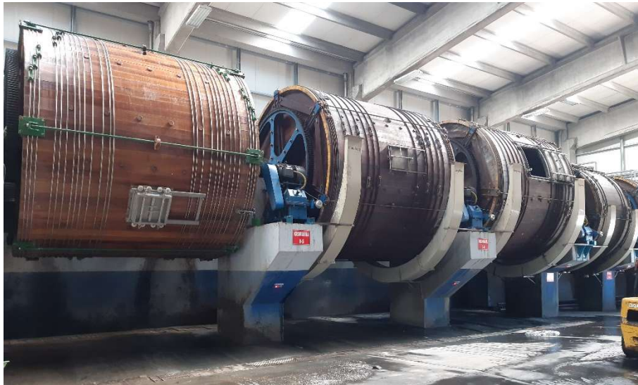
Görsel 5. Kireç Giderme, Sama, Pikle, Tabaklama işlemlerinin yapıldığı dolaplar
