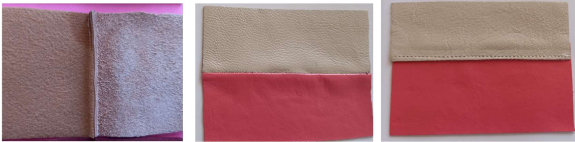
Görsel 7. Makine dikişi sırasıyla; dışa çatı, içe çatı, bindirme dikişi
