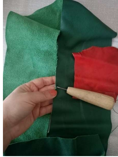
Görsel 14. Derinin biz ile delinme yöntemi
