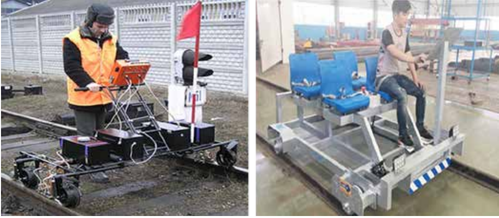
Şekil 4.32. Ray kusurları ölçme makineleri
