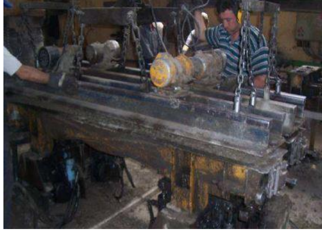
Şekil 3.17. Beton traverslerin sıkıştırılması
