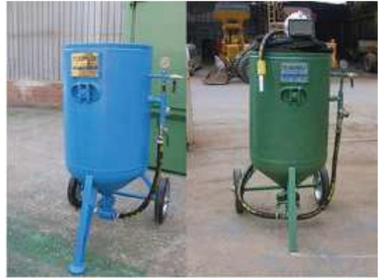
Şekil 5. Havalı Kuşlama Makinesi
