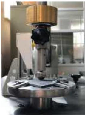
Fig. 2 Pin-on-disk test stand
