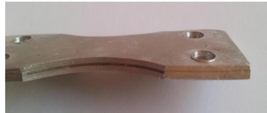
Şekil 2. Patlamalı kaynak yöntemiyle üretilen kompozit.
