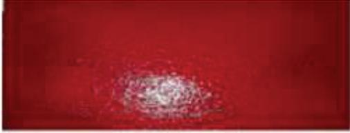
Şekil 7 c) Hiçbir işlem uygulanmadan boyama işlemine tabi tutulmuş parça
