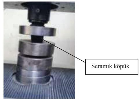
Şekil 5. Üretilen seramik köpüklere basma testi uygulaması
