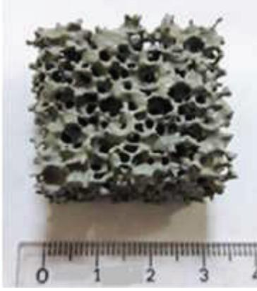
Şekil 3. Polimer süngerin seramik çamura daldırması ile oluşan yaş seramik köpük eldesi
