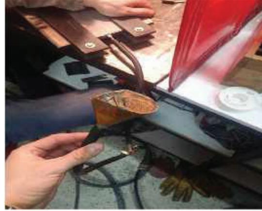
Şekil 1 Kaynaklanan malzemeye koruyucu gazın uygulanması
