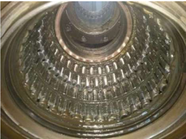
Şekil 13. Lityum basit sabun gres servis sonrası durumu
