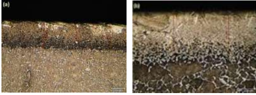
Şekil 1. 950 °C'de (a) 2,5 saat ve (b) 7,5 saat borlanan Ø11 mm çapındaki DIN 20MnCr5 çelik çubukların optik mikroyapısı ve tabaka kalınlıkları.
