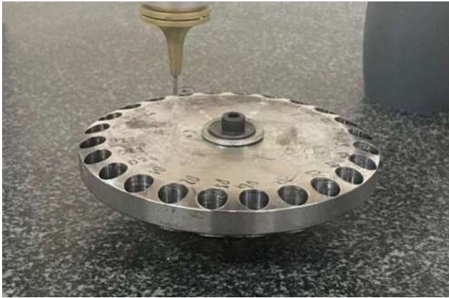
Fig. 1 Deliklerin Delindiği Deney Numunesi
