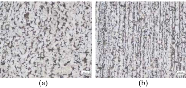
Şekil 2. (a) Taşlanmış ve (b) taşlanmamış yarı mamullerden üretilen Mn ve B içeren filmaşınlerin mikroyapısı.
