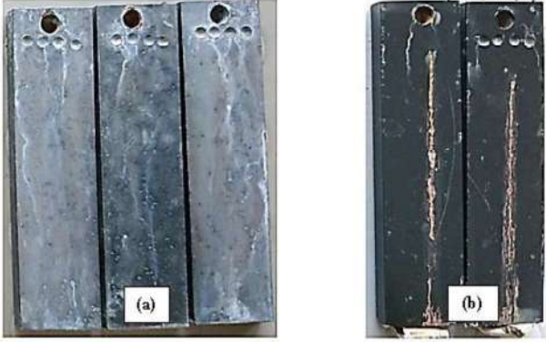
Şekil 5.3 İşlemsiz S355J2 çeliğinin (a) alkali çinko nikel kaplamalı ve (b) kataforez kaplamalı numunelerin korozyon sonrası yüzey görüntüleri
