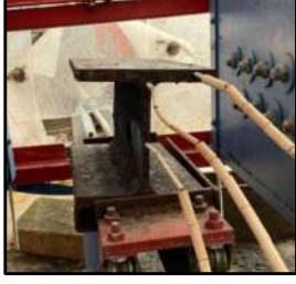
Şekil 1. Bir profilin bileşenlerinin (web/flanş bölgelerinin) ve sıcaklık ölçüm noktalarının gösterimi.
