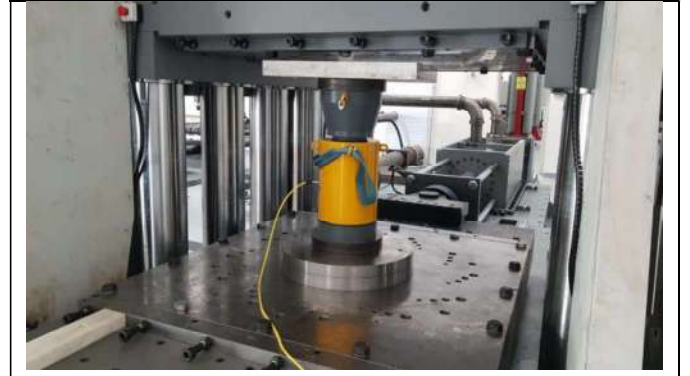
Şekil 6. ISO 7500-1 standardına göre referans kuvvet dönüştürücü ile test makinası kalibrasyonu
