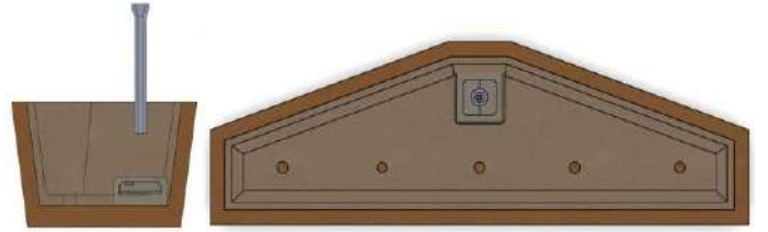
Şekil 7. Tandiș içinde turbostop çarpma bölgesi
