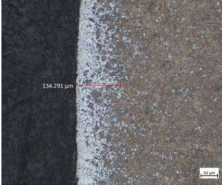
Şekil 11. Yağ verme sonrası dekarbürizasyon yapısı
