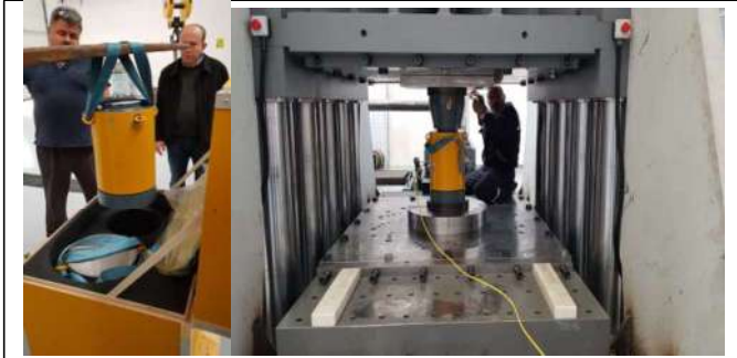
Şekil 4. Referans kuvvet dönüştürücünün test makinasına yerleştirilmesi
