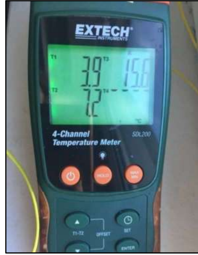
Şekil 3. Dış hava temaslı betonarme duvar sıcaklık ölçer cihazı ve verisi
