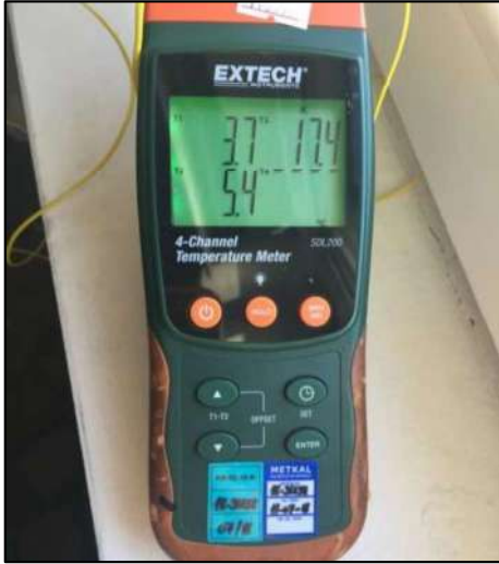
Şekil 2. Sıcaklık ölçer cihazı tuğla duvar verisi
