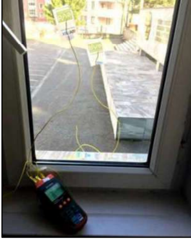
Şekil 1. Göstergeli sıcaklık ölçer cihazı prob bağlantı detayı.
