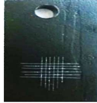
Şekil 6.2 Bilyalı dövme uygulanmış QSte 690 TM çeliğinin kataforez kaplama sonrası yapışma test yüzeyi
