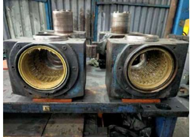
Şekil 14. CERAN XM 460 gres denemesi servis sonrası durumu
