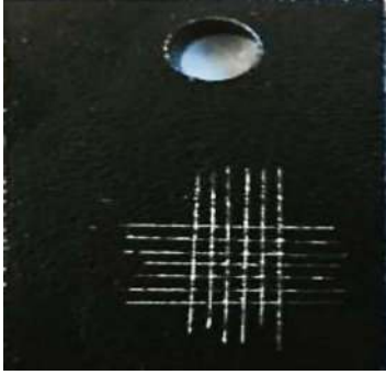
Şekil 6.4 Bilyalı dövme uygulanmış S355J2 çeliğinin kataforez sonrası yapışma test yüzeyi
