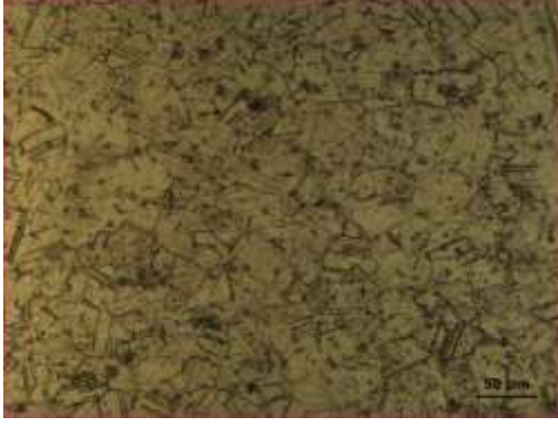
Şekil10. 1010 °C’de ısıtılma işlemine tabi tutulmuş numuneye ait mikro yapı görüntüsü
