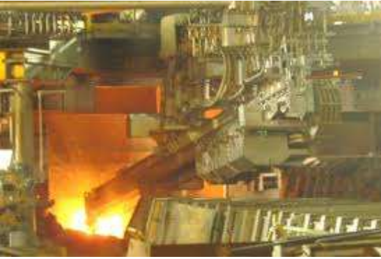
Şekil 5: Yüksek Fırınlarda özel tasarlanmış matkap ile döküm açma işlemi [8]
