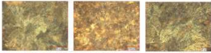
Şekil 4. Konvansiyonel R260 ray çeliği mikroyapısı a) 100x, b) 500x, c) 1000x
