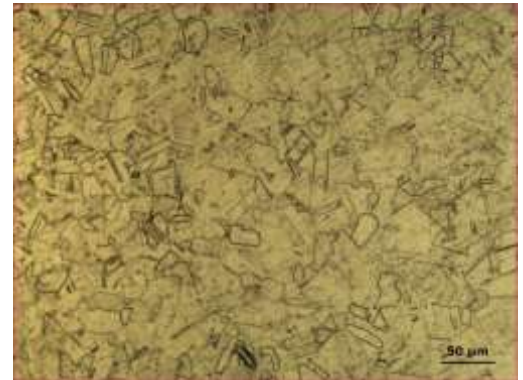
Şekil9. 990 °C'de ısıtılmış numuneye ait mikro yapı görüntüsü
