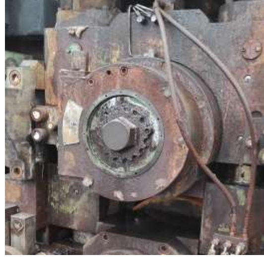
Şekil 3 Air-oil sistemi kullanılan hadde merdane yatağı
