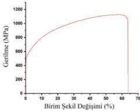
Şekil6. 990 °C'de ısıtılmış numuneye ait Gerilim-Birim Şekil Değişimi (%) grafiği.
