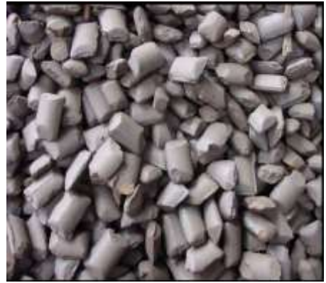
Şekil 2 Sıcak briketlenmiş demir
