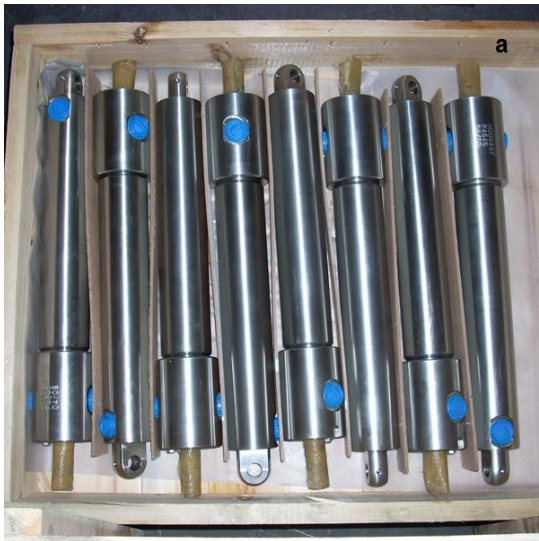
Şekil 6 a) Sistemin çıktısı olan hidrolik silindirler, b) Hidrolik silindir montaj teknik resmi
